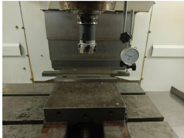
Figure II.7 : centre d'usinage vertical que représentée l'opération de surfaçage.
