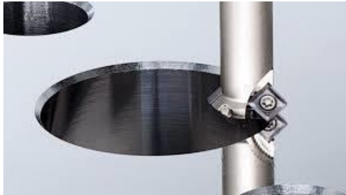
Figure I.17: Opération de Chan freinage et outil de coupe [18]
