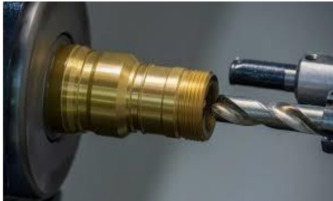
Figure I.14: Opération perçage et outil de coupe [17]
