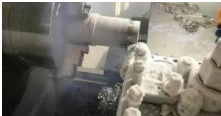
Figure I.4 : Technique de lubrification par Cryogénie
