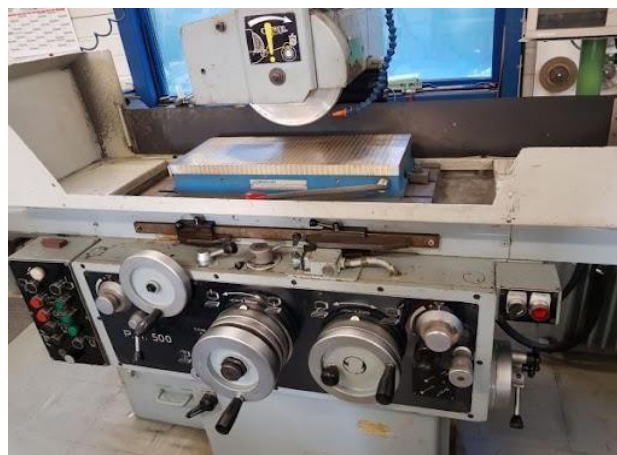
Figure II.8 : une rectification plane M7 130
