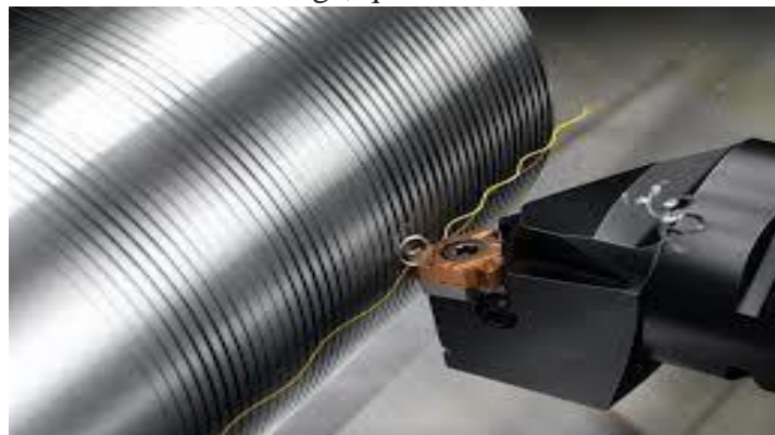
Figure I.16: Opération de filetage et outil de coupe [17]
