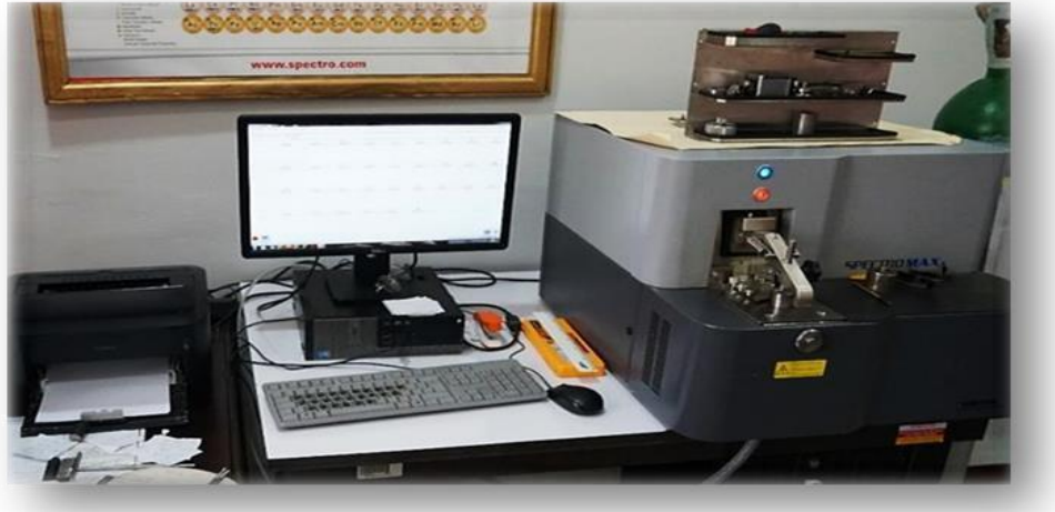
Figure II.1 spectromètre Type de SPECTROMAX
