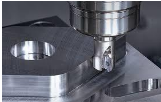
Figure I.26: Opérations de l'épaulement
