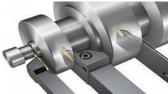
Figure I.15: Opération Rainurage n et outils de coupe [17]
