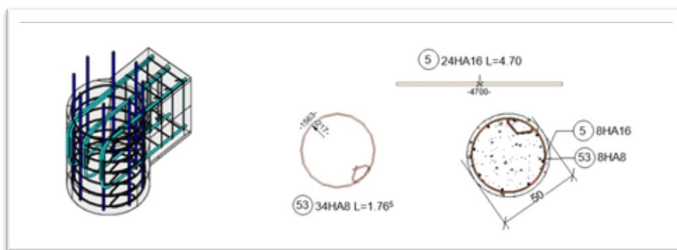
Figure V.6: Schéma de ferrailage de poteaux circulaires.
