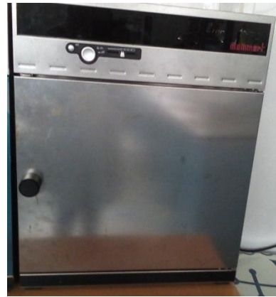
Etuve universelle de 5 à 220°C avec ventilation (MEMMERT)
