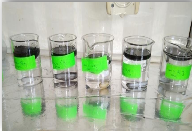
Figure 31: Différentes masses de charbon actif et même concentration de benzène .
