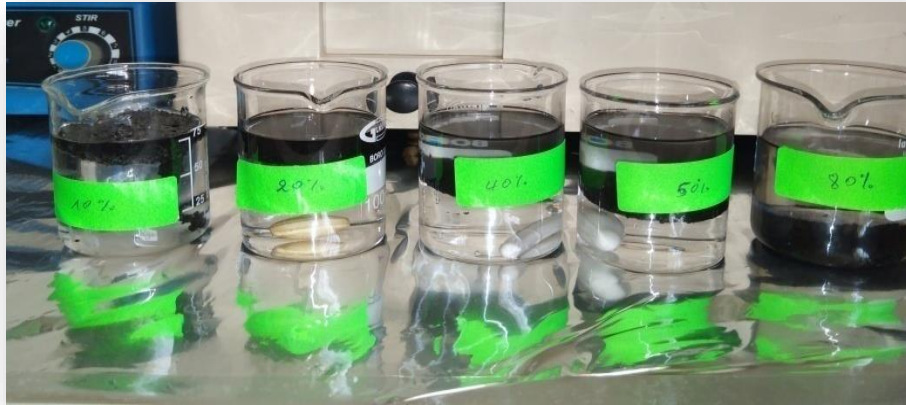
Figure 30 : Différentes concentrations de benzène et même masse de charbon actif.
