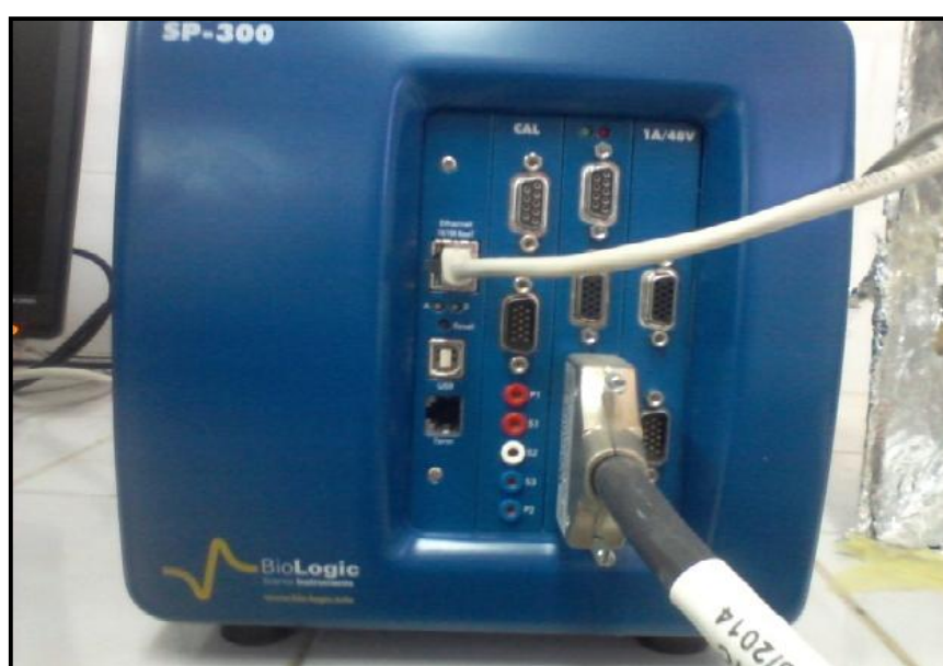
Figure 3.1. potentiostat/galvanostat (PG) utilisé pour l'analyse électrochimique.
