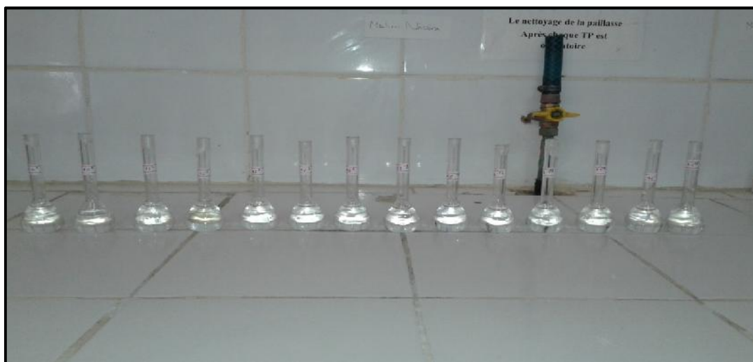
Figure 3.8. préparation des solutions du chlorure de Zinc à différents concentrations dans une solution tampon de PBS à PH 4.
