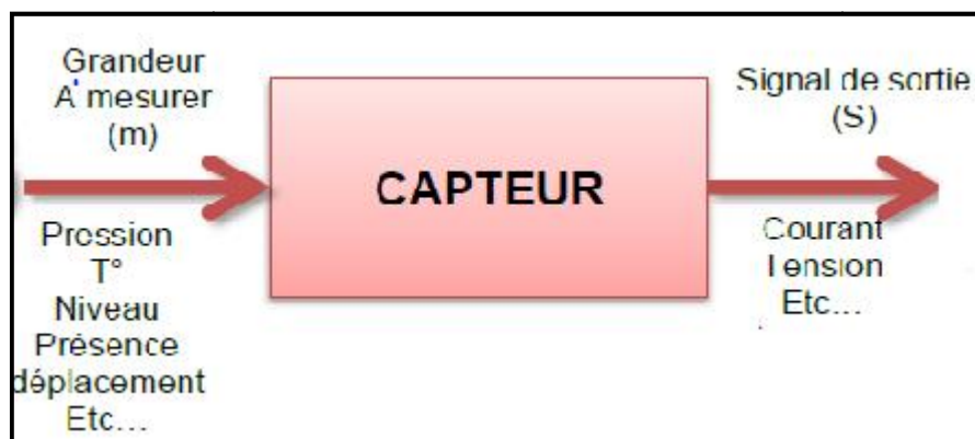
Figure 1.1. Schéma synoptique d'un capteur [5].
