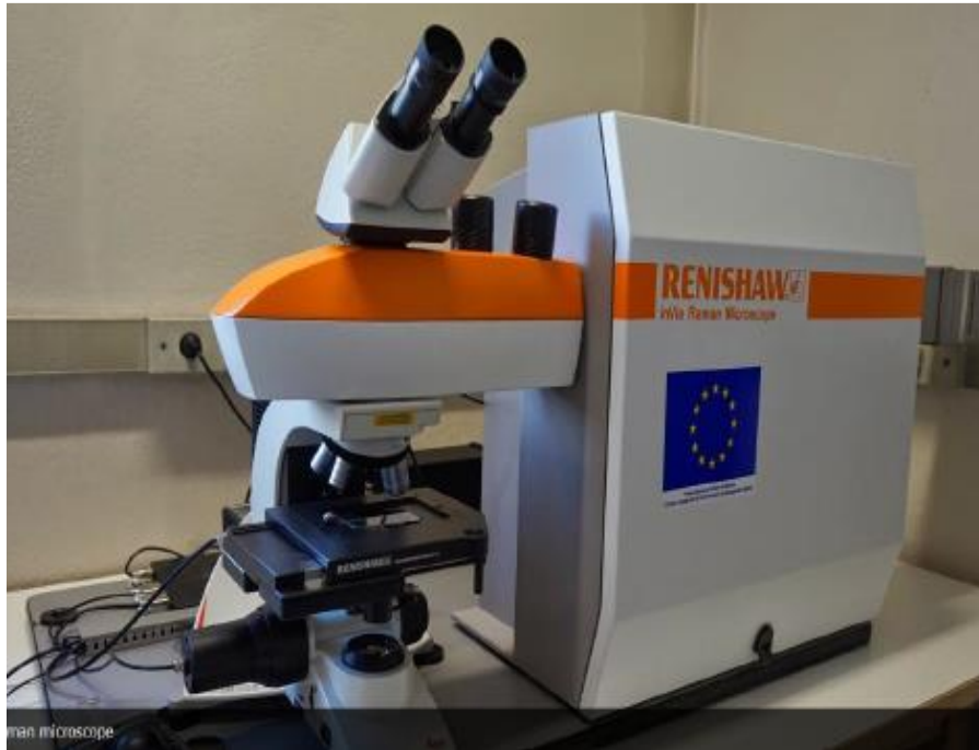
Figure 10 : Photographie de spectromètre Raman (Renishaw InVia).
