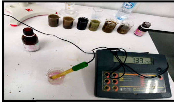
Fig.25: Mesure de la CE de la boue avec un conductimètre.
