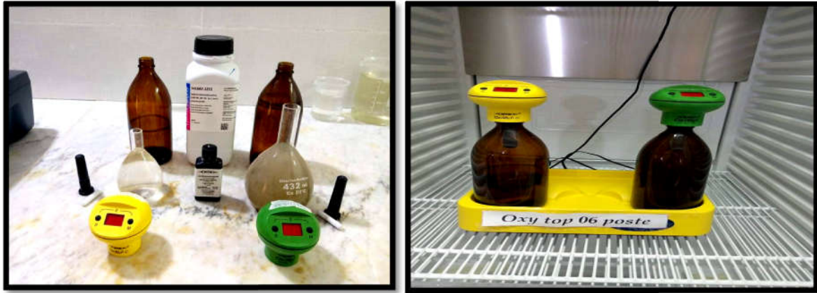
Fig.16: La mesure de DBO5 dans 5 jours dans une armoire thermorégulatrice
