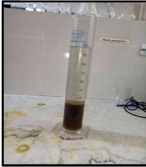
Fig.21: Test de décantation
