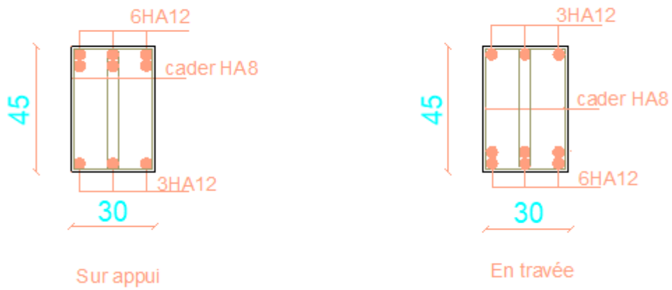
Figure V.1 : Ferrailage de poutre principale.
