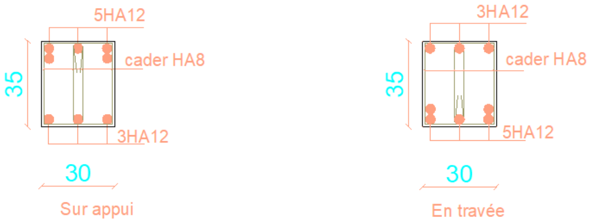
Figure V.2 : Ferrailage de poutre secondaire.
