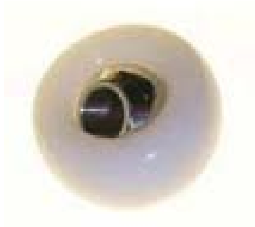
Figure I-13: Exemple de couple de frottement métal/UHMWPE. [41]
