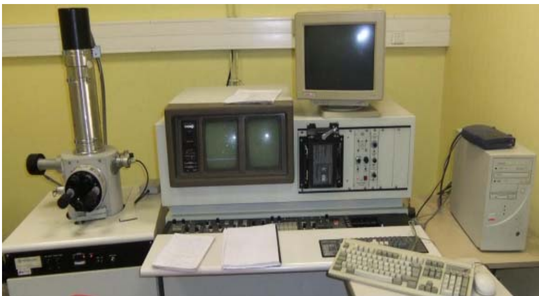
Figure II-6 : MEB de marque HITACHI S-520 au MSMP Arts et Métiers ParisTech Lille.
