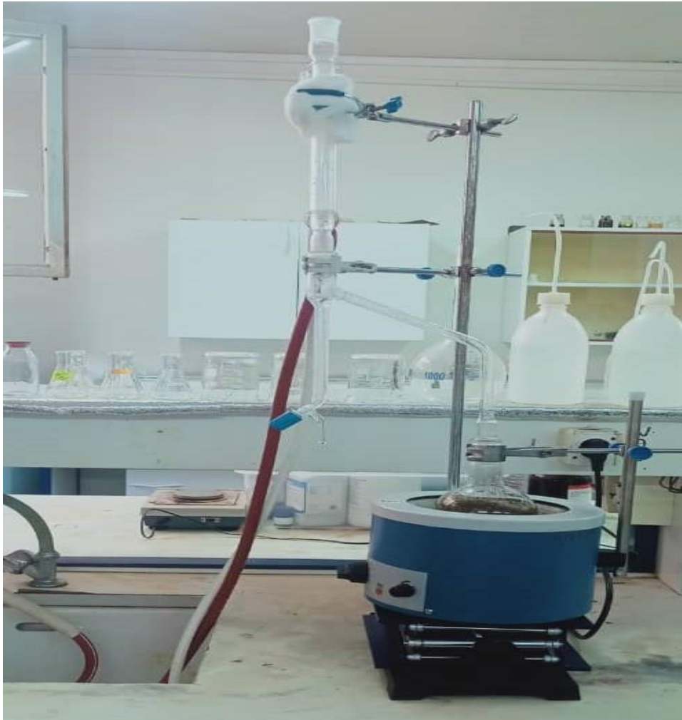
Figure IV. 11 : Montage (clivengere) de l'extraction de l'huile essentielle par hydrodistillation de origanum majorana et le thymus vulgarise (Photo originale, 2023).
