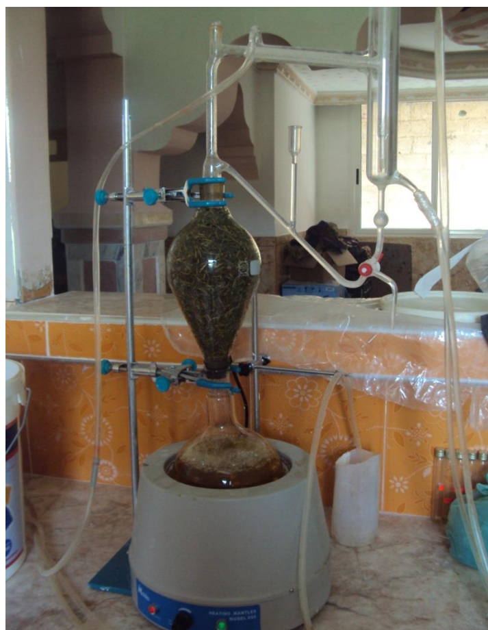
Figure 9 : Montage de la distillation par entraînement à la vapeur d'eau (clewenger).
