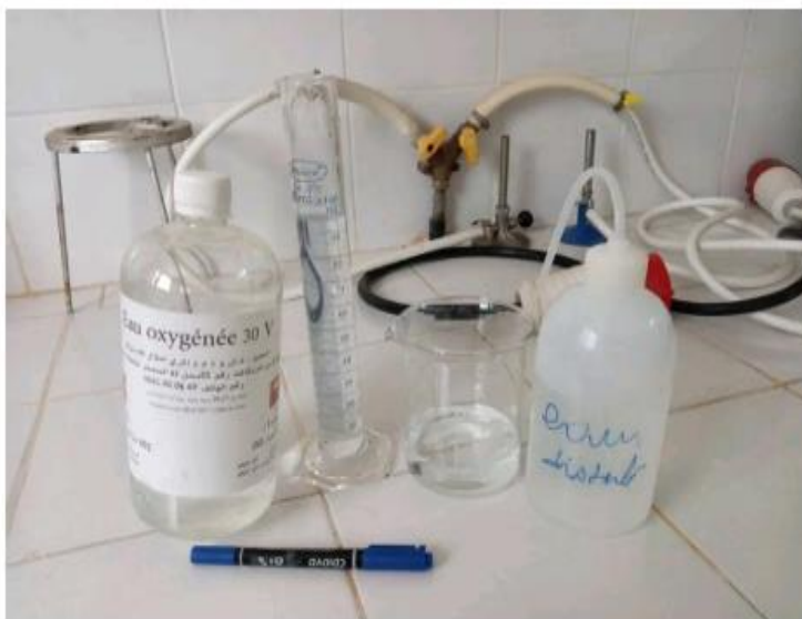
Figure 12: Préparation de H_2O_2 15% par la dilution de H_2O_2 30%.
