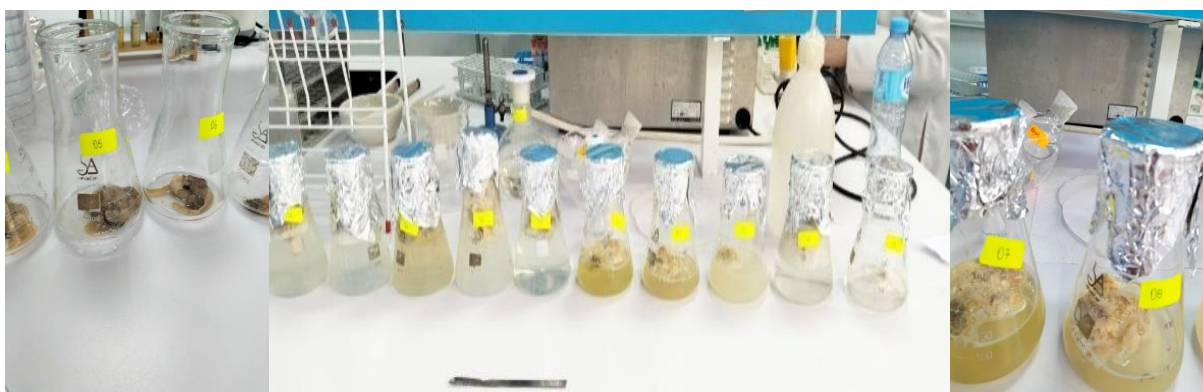
Figure 11: Dégradation de la matière organique par la solution H_2O_2 15%.
