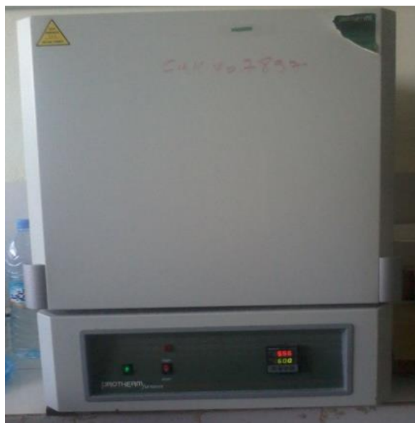
Figure 16 : Mesure de la teneur en cendre par une four à moufle
