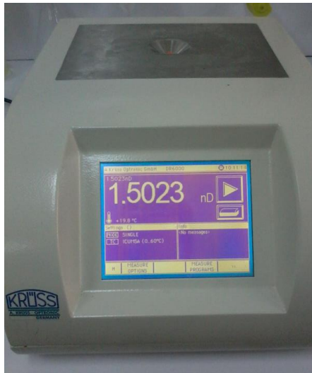
Figure 15 : mesure de l'indice de réfraction
