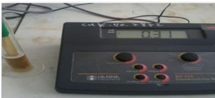
Figure 14: Mesure de la conductivité électrique du miel
