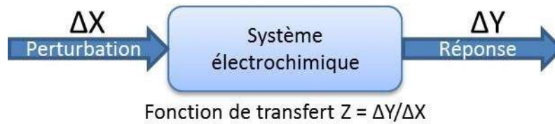
Schéma 2.1: Principe général de la spectroscopie d'impédance électrochimique [7].
