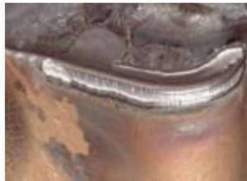
Figure II.8 : Usure en dépouille (abrasion).
