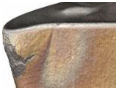
Figure II.13 : Usure thermique (déformation plastique).
