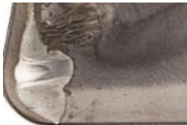
Figure II.10 : Usure en cratère (chimique).
