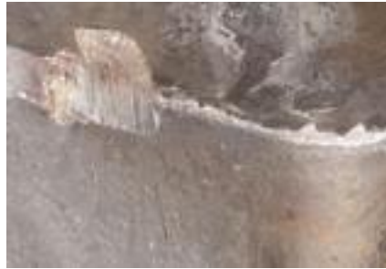
Figure II.12 : Usure par adhérence (Arête rapportée).
