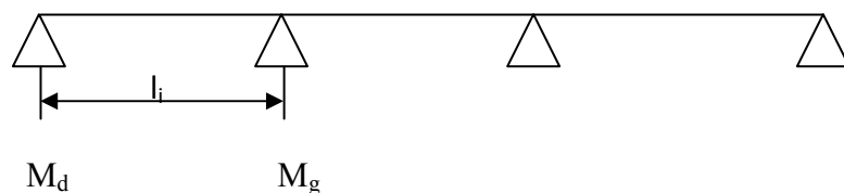
Figure III.17. Schéma statique de la poutrelle
