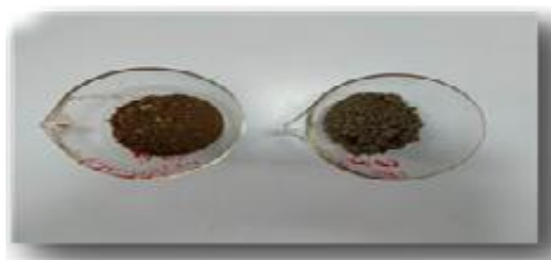
Photographie 7. Test d'humidité selon la méthode gravimétrique.
