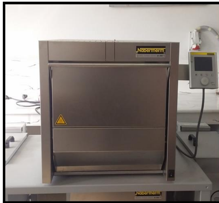
Figure III.4. Four de Nabertherm pour austénitisation de l'acier 30CrMnTi.
