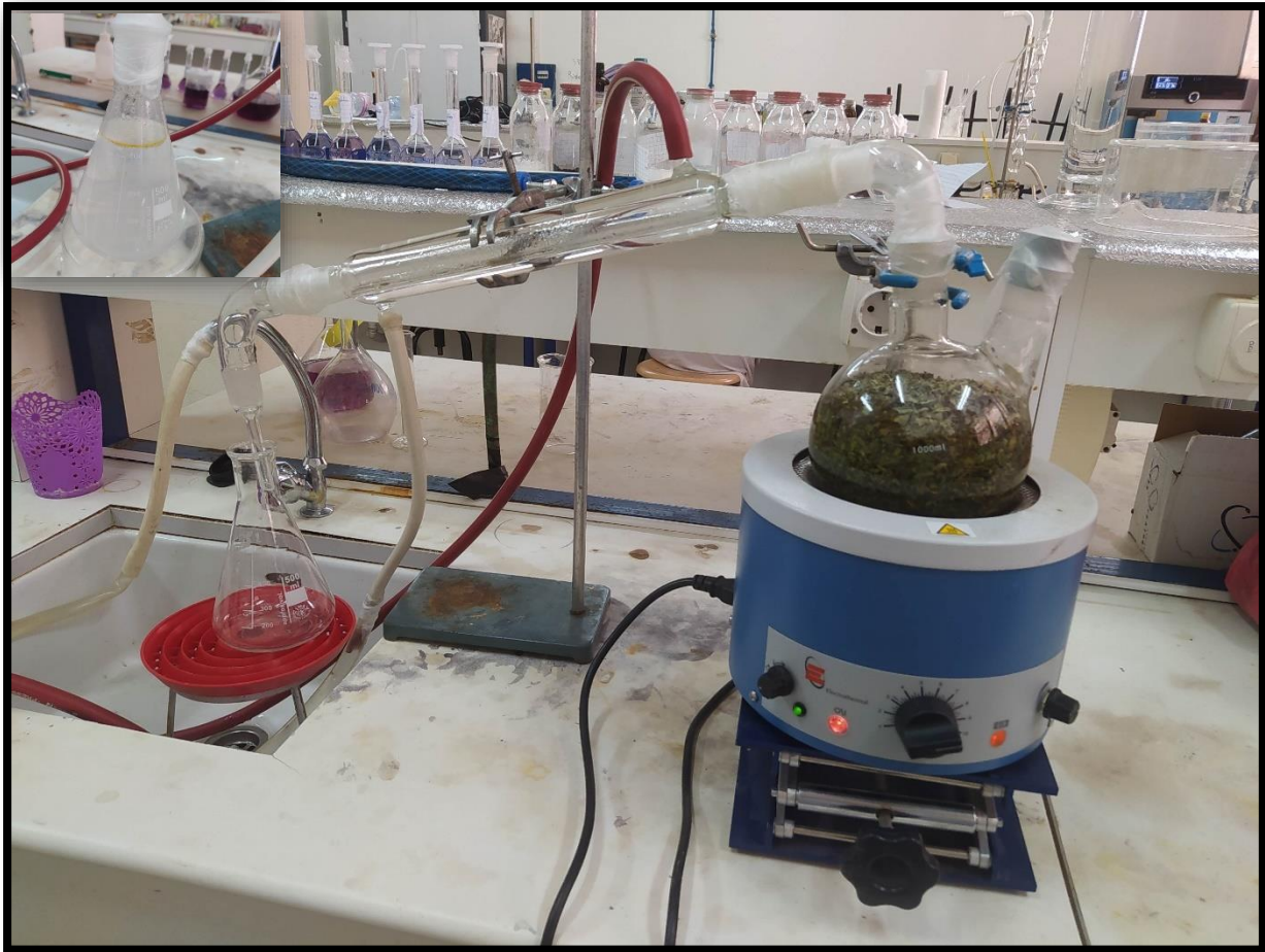
Figure V. 19 : Montage de l'extraction de l'huile essentielle par hydrodistillation du thym (Photo originale, 2022).
