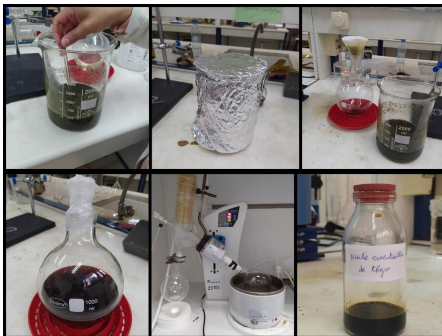
Figure V. 27 : Les étapes d'extraction des extraits aromatiques de la plante de thym par macération
