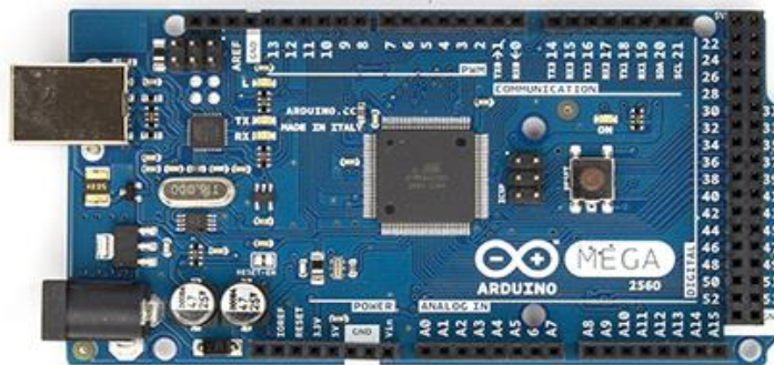
Figure II.5 : La carte Arduino Méga 2560
