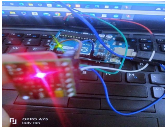
Figure IV.16 Branchement le module MAX30100 avec la carte Wemos
