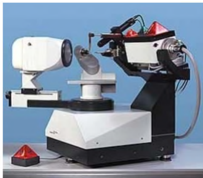
Figure III.5 : Diffractomètre à rayons X de géométrie Kappa CCD
