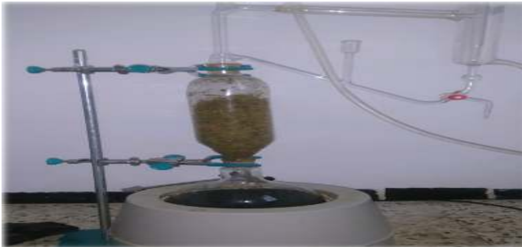
Figure 1: Le dispositif de l'hydrodistillateur ou entrainement à la vapeur (photo originale)
