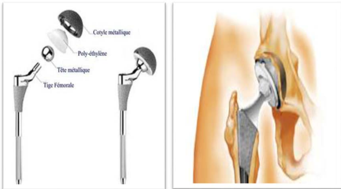
Figure 3 : Eléments constituant une prothèse totale de hanche modulaire.
