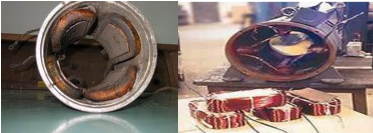
Figure II.4 : Inducteur à aimants permanents et Inducteur bobiné
