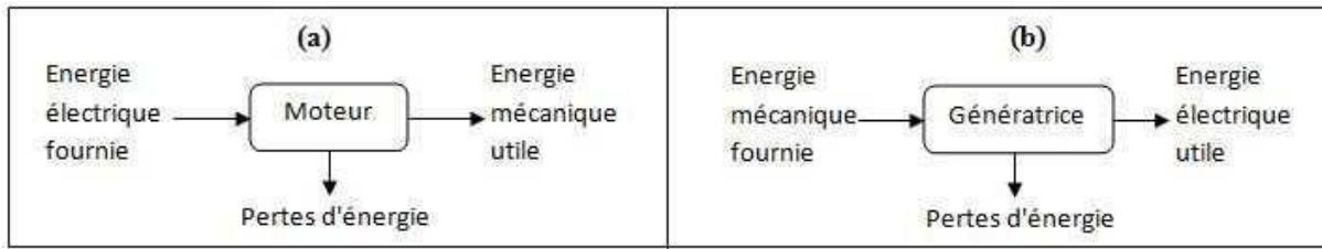
Figure II.1 : Transformation de l'énergie dans une machine MCC
