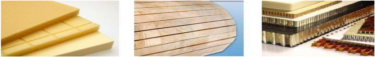
Figure : 1.21. Exemples d'âmes les plus utilisées dans la construction des composites sandwichs : a) mousse, b) balsa bois c) nid d'abeilles [8].
