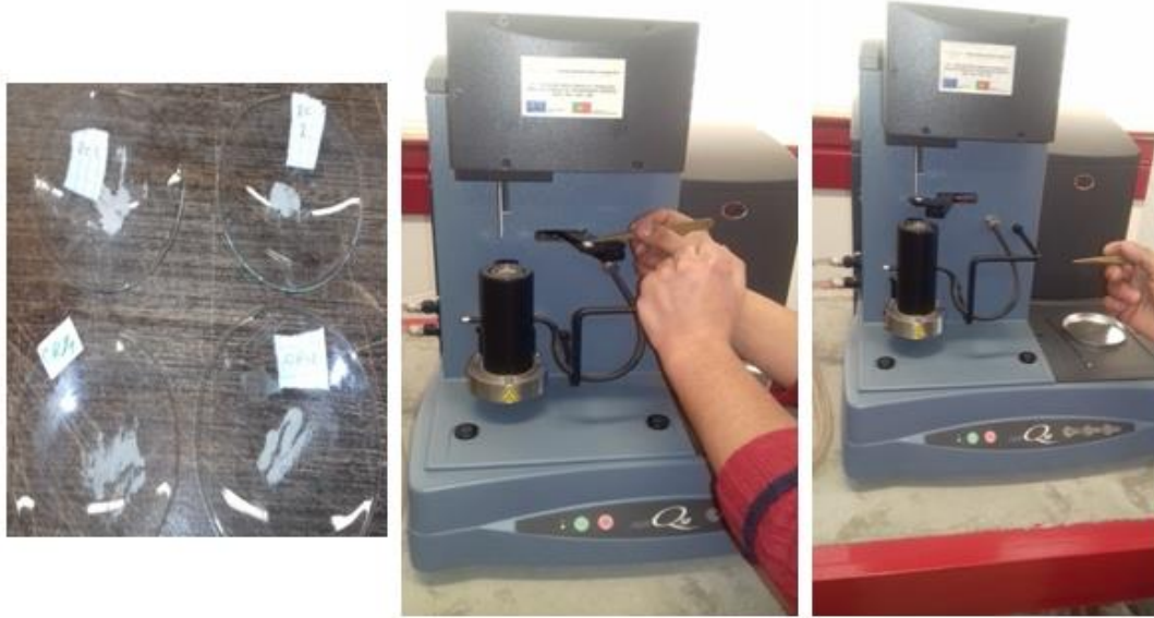
Figure II.20. Préparation des échantillons pour l'ATG
