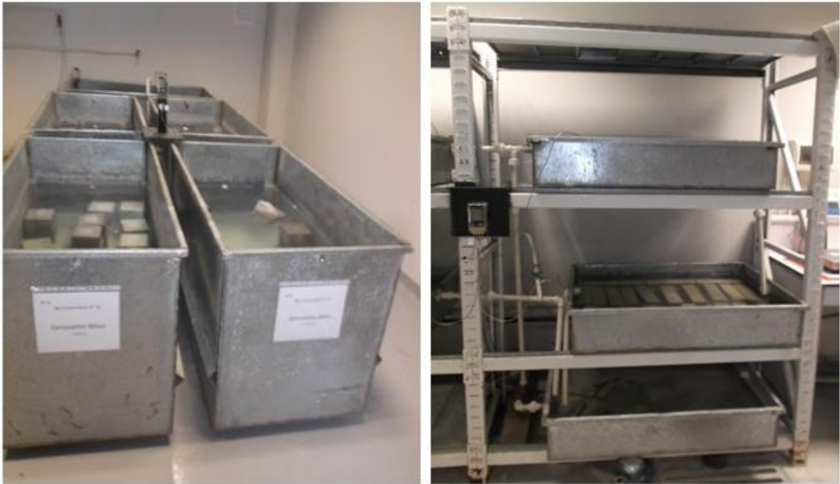
Figure II.10. Conservation des échantillons dans l'eau potable (Lafarge HOLCIM)
