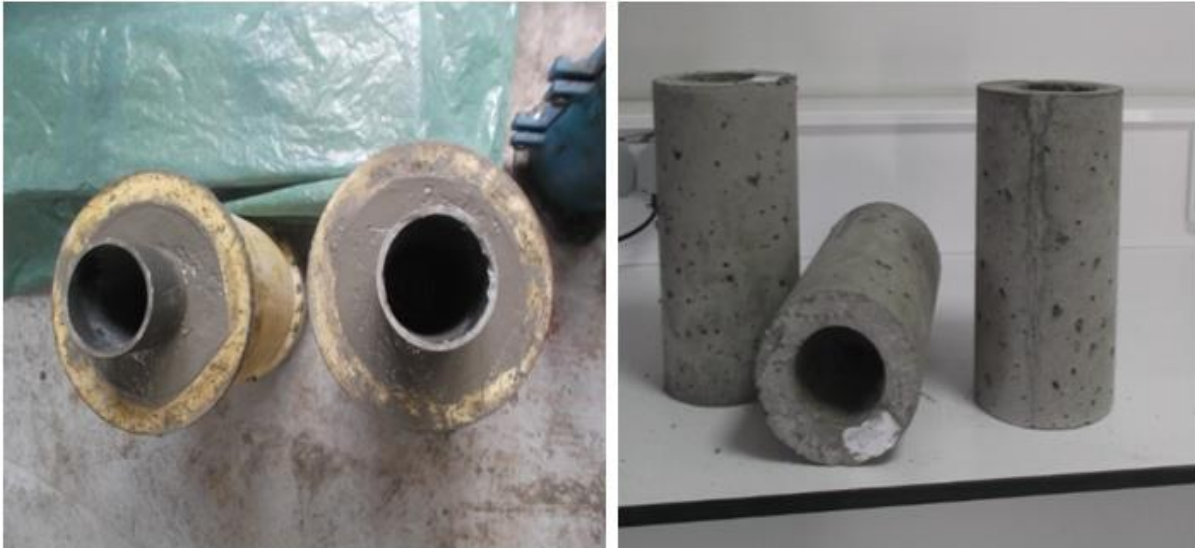
Figure II.6. Éprouvettes cylindriques évidés (15x30cm)
