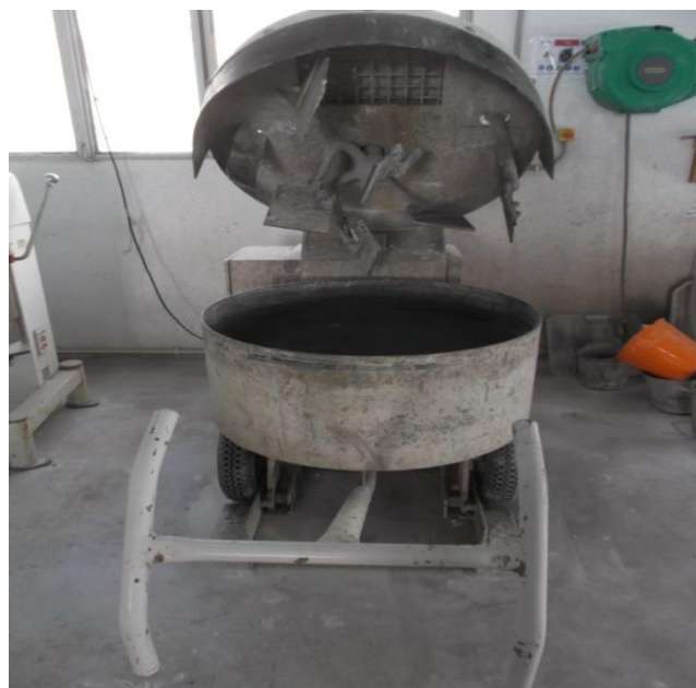
Figure II.5. Malaxeur à béton (Lafarge HOLCIM)
