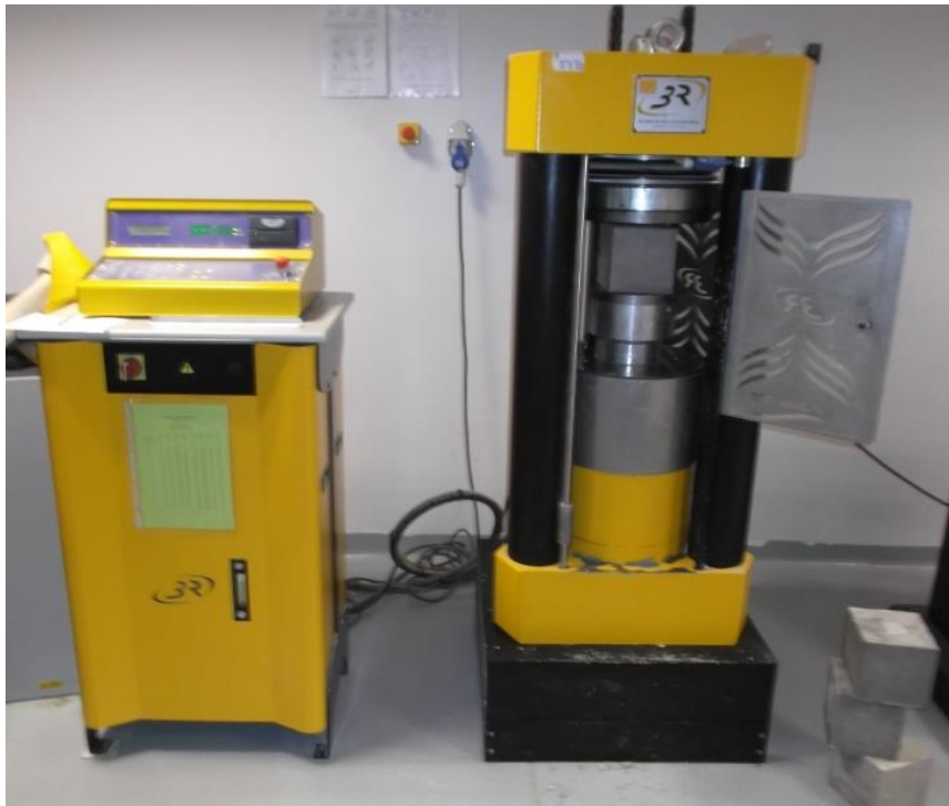
Figure II.12. Presse hydraulique mesure la compression (Lafarge HOLCIM)
