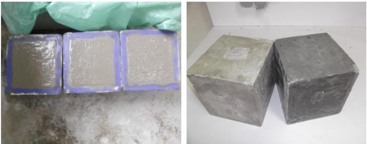
Figure II.7. Éprouvettes cubiques (15x15cm)
