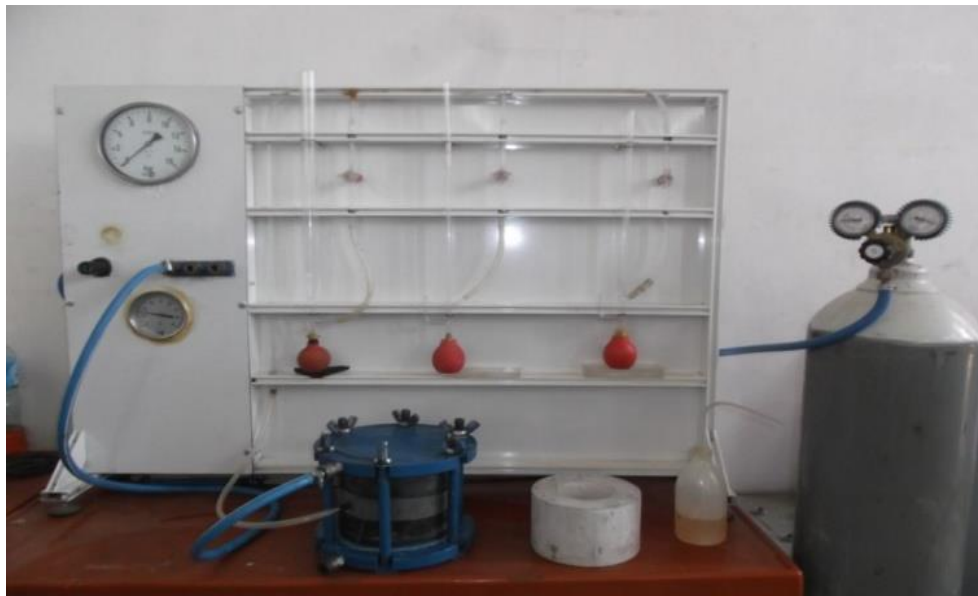
Figure II.14. Dispositif de mesure de la perméabilité à l'oxygène – USTHB, Alger
