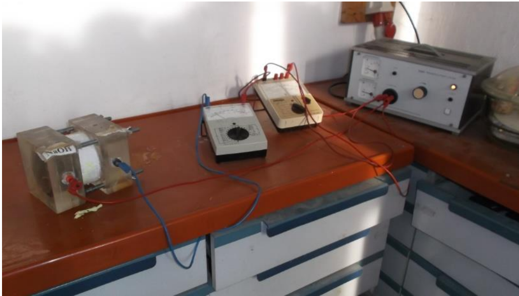
Figure II.16. Dispositif de mesure de la perméabilité aux ions chlorure – USTHB, Alger
