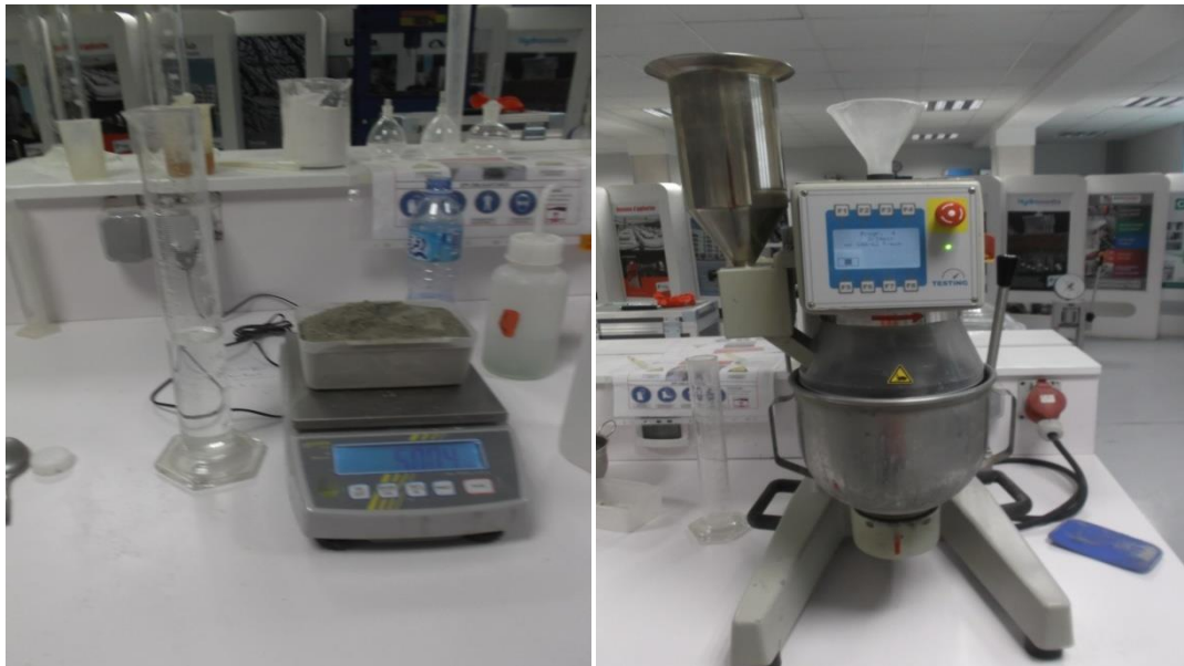
Figure II.4. Préparation la pâte de ciment (Lafarge HOLCIM)
