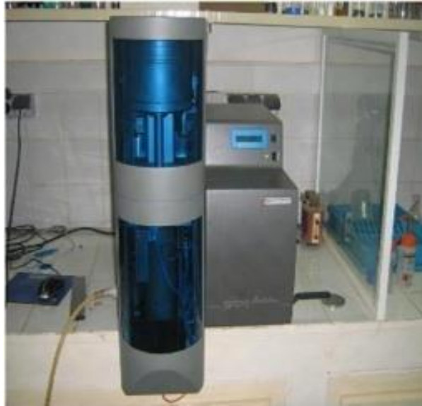
Figure II.21. Dispositif ATD / ATG (URMPE M'hamed Bougara, Boumerdes)
