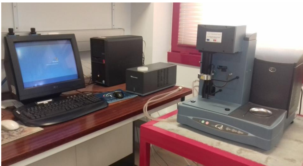
Figure II.19. Dispositif utilisé pour l'analyse thermogravimétrique – UBI, Portugal
