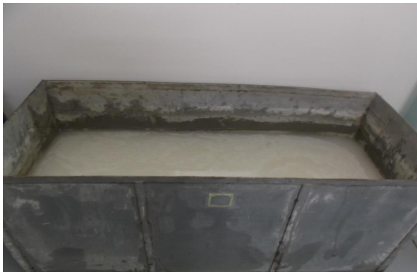
Figure II.11. Conservation des échantillons dans l'eau séléniteuse (Lafarge HOLCIM)
