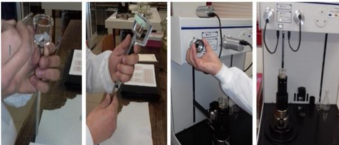
Figure II.18. Préparation de l'échantillon pour l'essai de MIP – UBI, Portugal
