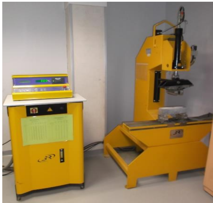
Figure II.13. Presse hydraulique mesure la flexion 4 point (Lafarge HOLCIM)
