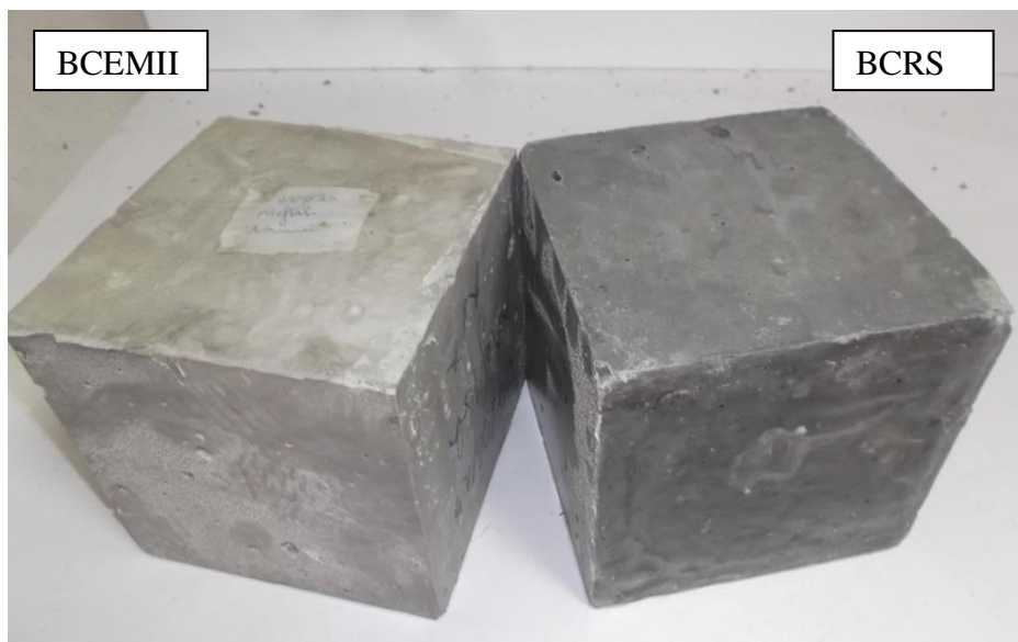
Figure III.19. Echantillons des deux bétons, après 360 jours d'immersion dans l'eau séléniteuse.
