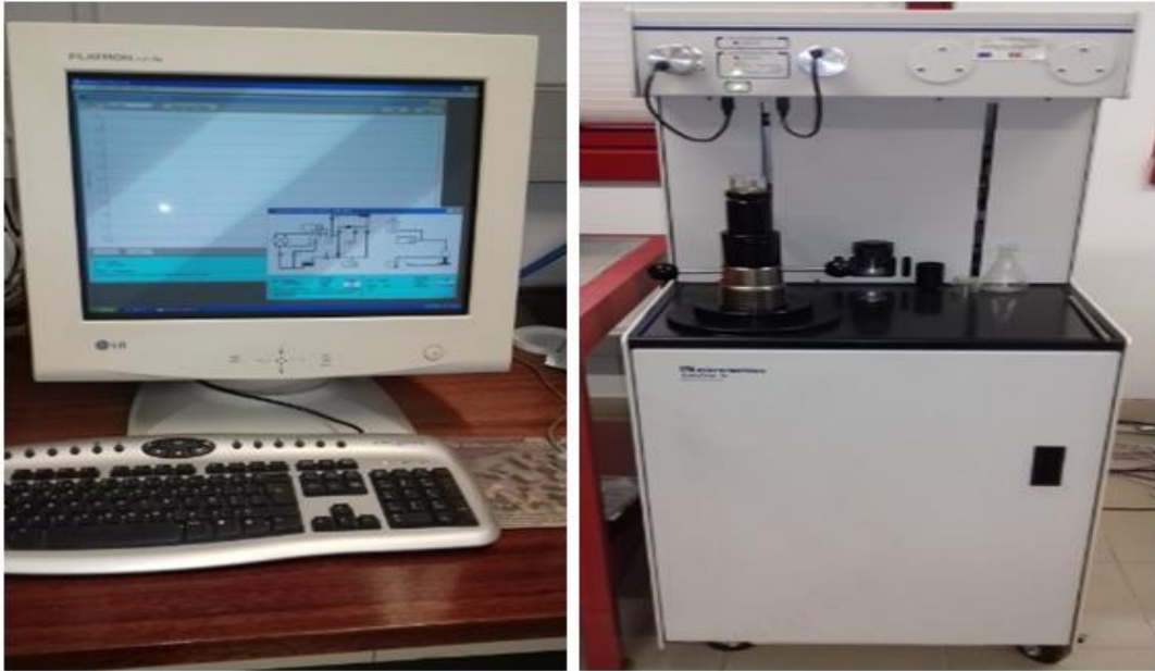
Figure II.17. Dispositif de mesure de la porosité au mercure (UBI-Portugal)
