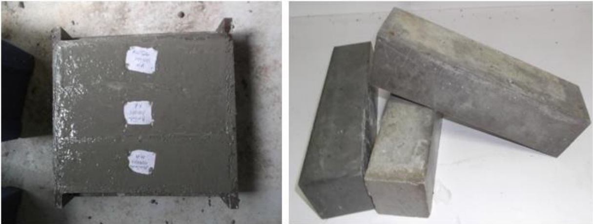
Figure II.8. Éprouvettes prismatiques (7x7x28cm)
