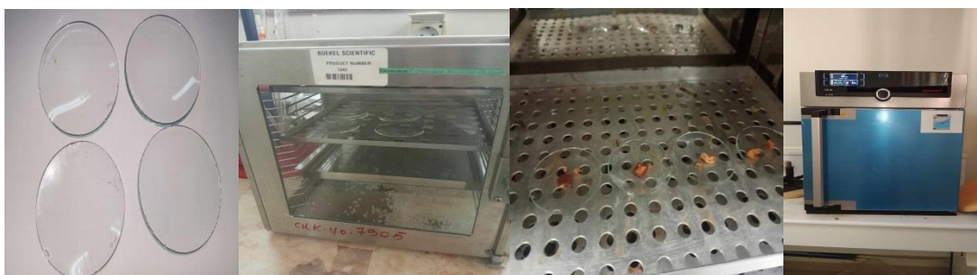
Figure 12: Illustration des étapes de la détermination de la teneur en eau (photo originale).
