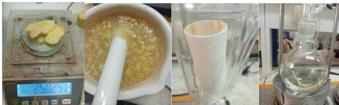
Figure 15: Illustration des étapes de la détermination de la teneur en lipides. (Photo originale).
