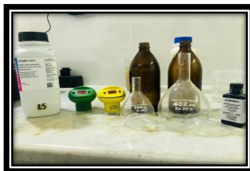
Figure 27: équipements utilisés pour la mesure de la DBO5
