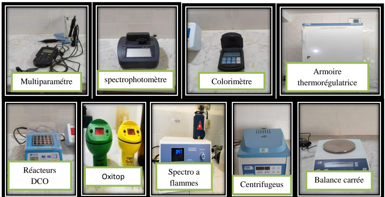
Figure 23 : appareils utilisés au laboratoire de la STEP
