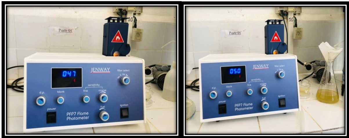
Figure 39 : Résultats de transmittance du Na d'eau d'entrée et de sortie
