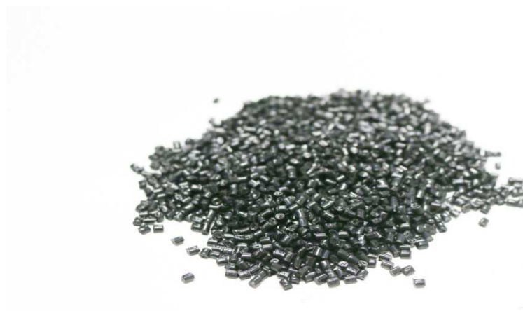
Figure II.6 Matière constituée d'une matrice polyamide renforcé par particules de verre
