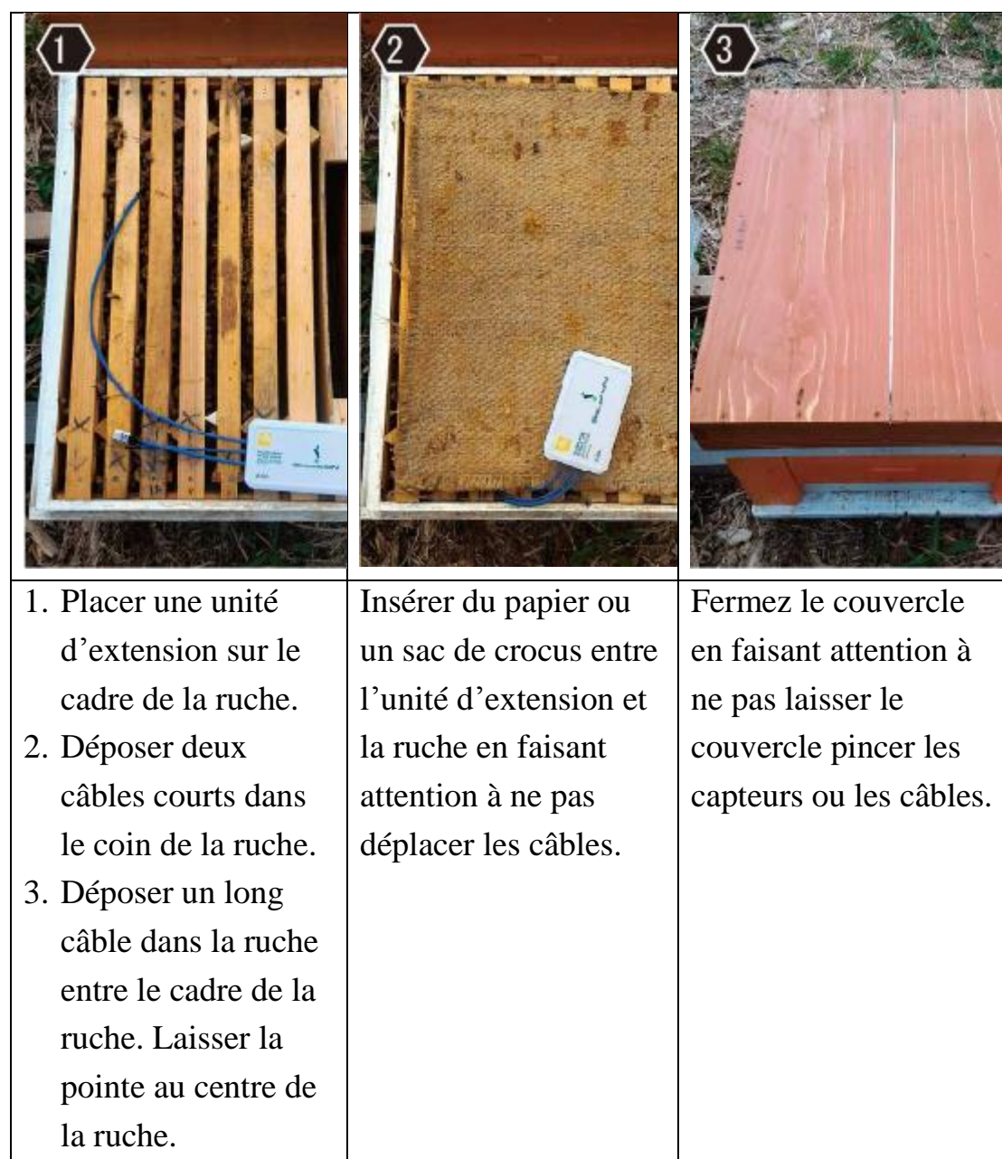
Figure III-3. Exemple d'installation d'un capteur dans une ruche
