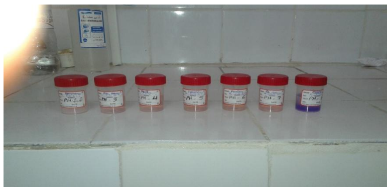
Figure3.1. différents pH pour une concentration fixe 10^{-2} en ions de cobalt
