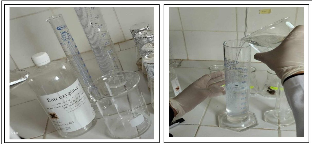
Figure 22: Préparation de H_2O_2 15% par la dilution de H_2O_2 30%.
