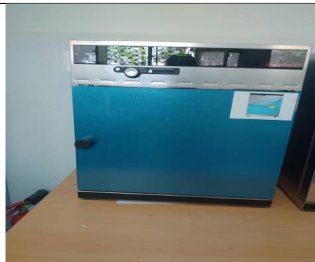
Etuve universelle de 5 à 220°C avec ventilation (MEMMERT)
