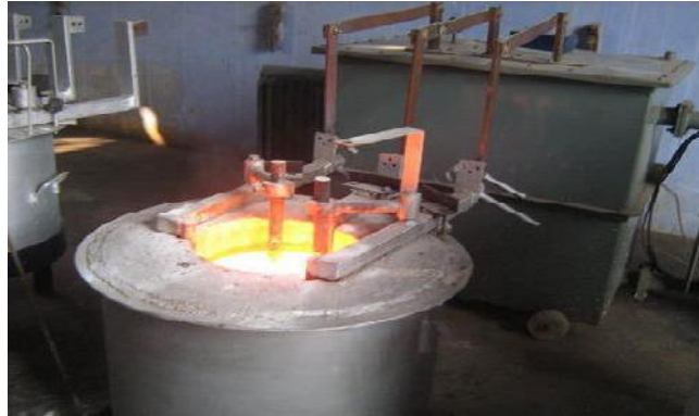
Figure.II.2. Four de nitruration en bain de sel [7].
