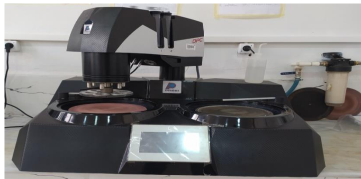
Figure III.8. Machine automatique de polissage.
