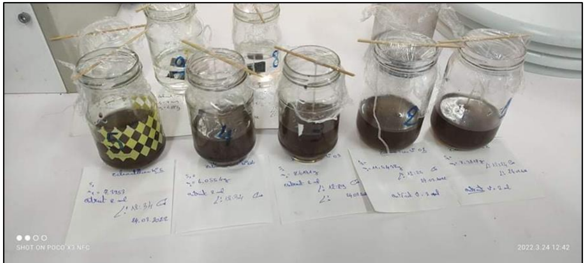
Figure III.12 : échantillons de l'acier immergé dans une solution (HCL+ inhibiteur)
