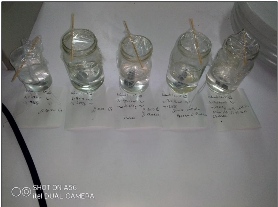
Figure III.11: échantillons de l'acier immergé dans une solution corrosive
