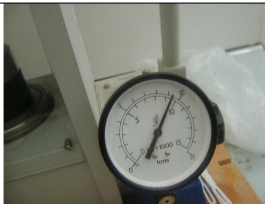
Cadran de lecture de la pression Indiquant ~10 t appliquée lors du pastillage
