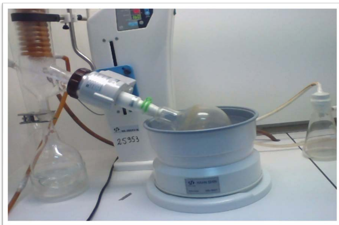
Figure 07: du Rotavapor utilisé pour sécher nos extraits méthanoliques.
