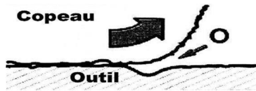
Fig. II. 24. Processus d'usure par oxydation.
