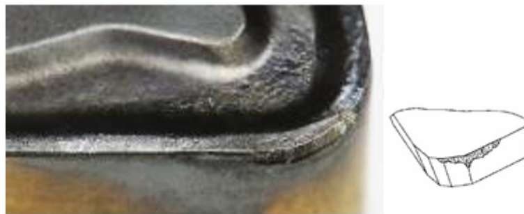
Fig.II.27 Usure en dépouille (abrasion)
