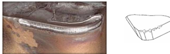
Fig. II.28. Usure en entaille (adhérence).
