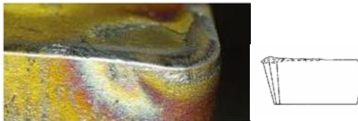
Fig. II.30. Usure thermique (déformation plastique)
