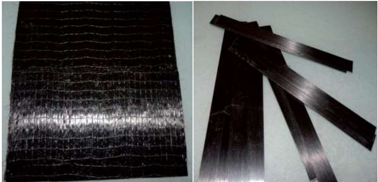
Figure 3.5 : Photo d'une plaque composite stratifiée au contact et de plats pultrudés
