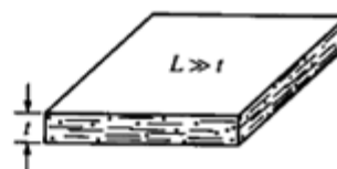
(b) Orientation aléatoire en 2D lorsque la longueur des fibres est plus grande que l'épaisseur de la pièce
