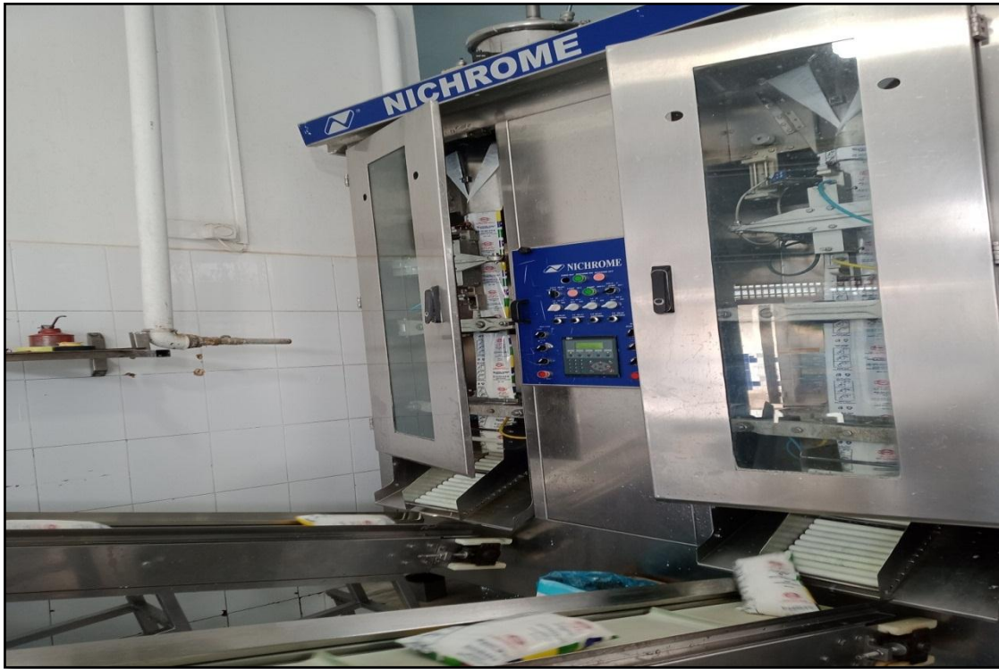
Figure 15 : Conditionneuse verticale du lait pasteurisé (la laiterie Athmani).
