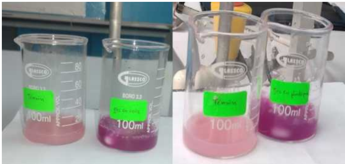
Figure 17 : Détermination de l'acidité titrable par le virage de couleur des échantillons A et B.
