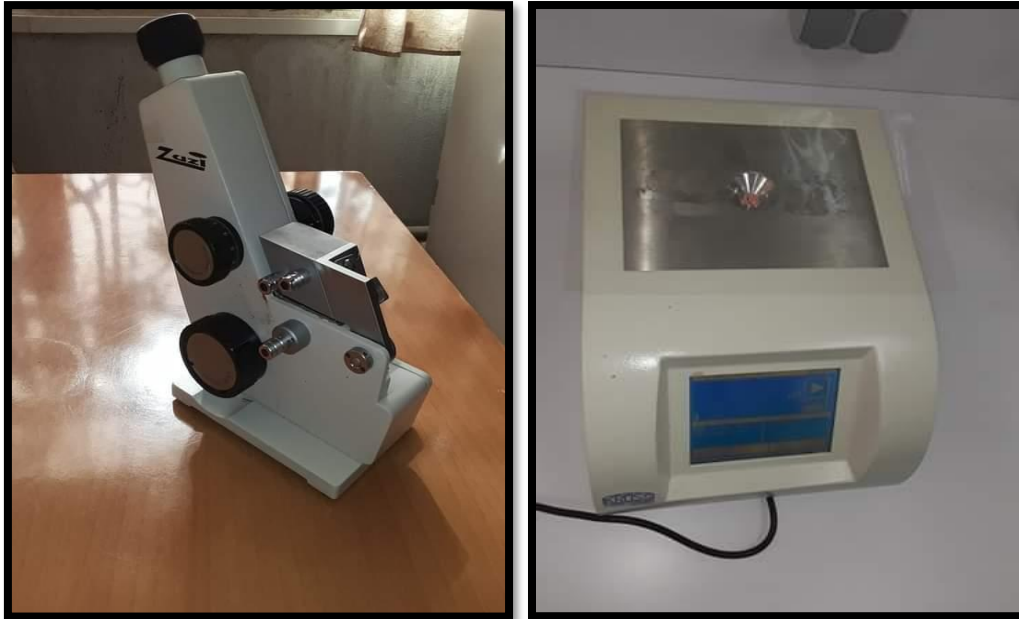
Réfractomètre manuelle (d'Abbe) Réfractomètre électrique
