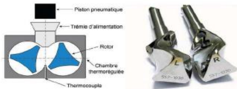
Figure III.2: Image d'un mélangeur interne : (a) Chambre de malaxage, (b) Géométrie des rotors contrarotatives.
