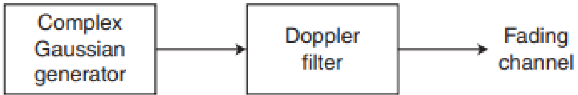
Figure 3.2. Modèle FWGN dans le domaine temporel
