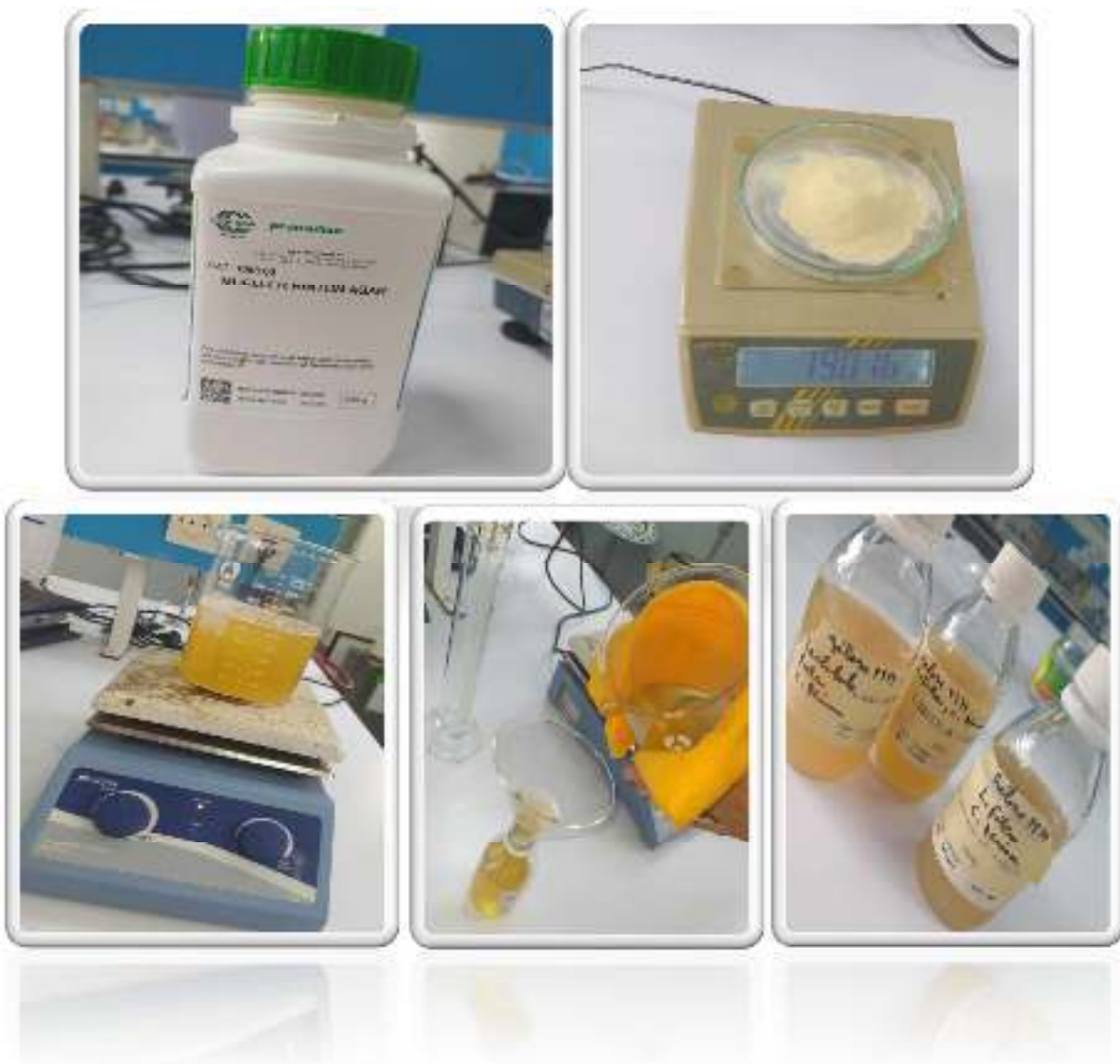
Figure 12. Les étapes de la préparation de la gélose Mueller-Hinton (MH).
