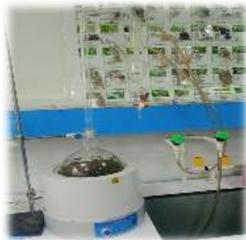
Figure 11. Le montage d'hydrodistillation (Clevenger)
