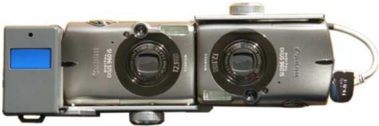
Figure 3.23 Canon montés ensemble et synchronisés par le logiciel StereoData Maker
