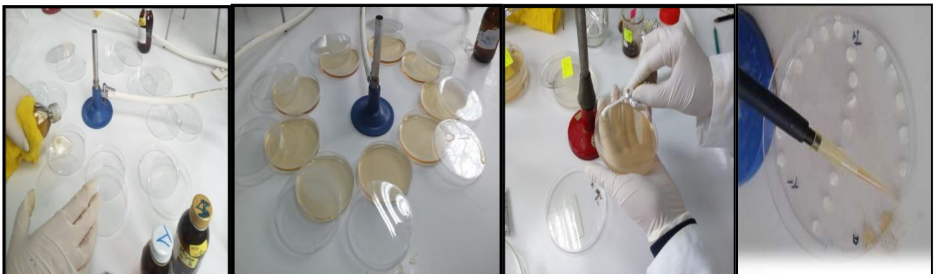
1. Couler la gélose dans les boîtes 2. Les boîtes de pétrie dans une zone stérile 3. Frotter l'écouvillon 4. Préparation des disques
