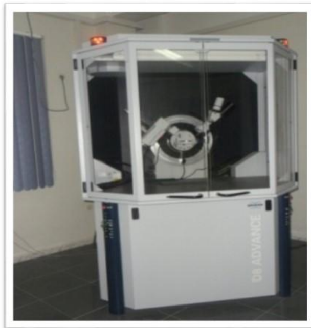
Figure II.8 : Diffractomètre de rayons X type D08 ADVANCE.
